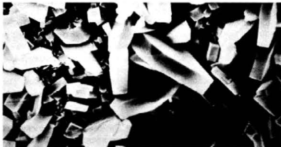
Figure 9. SEM image of XY clinoptilolite, Idaho.
